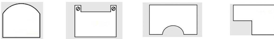
Peças geométricas com recortes que fragilizam para os processos de têmpera e corte, formas com muitas curvas ou complexas, ângulos de 90°. Lapidação Manual
