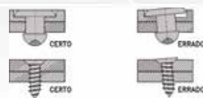
Fixe corretamente parafusos ou rebites
